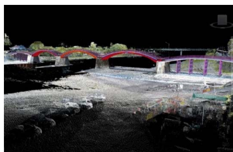
図 2-8 錦帯橋の点群データ
