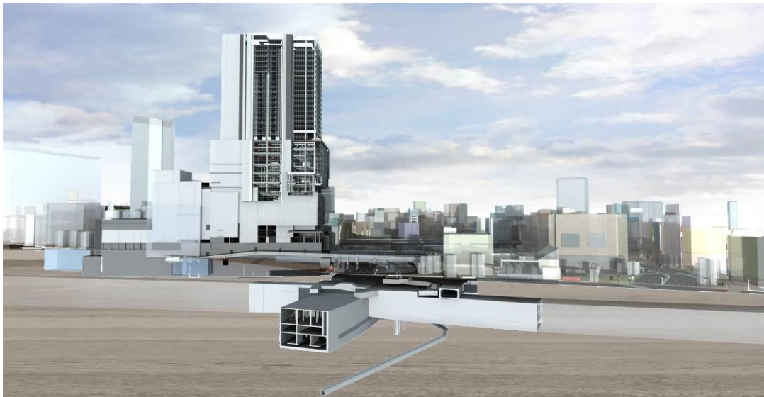
図 4-46 建築の BIM データと土木の CIM データを融合した UiM
